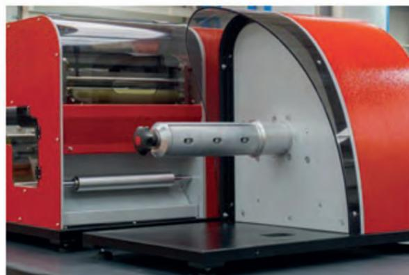
• Externe Rollenaufwicklung für bedruckte Etiketten „Rolle-zu-Rolle“
